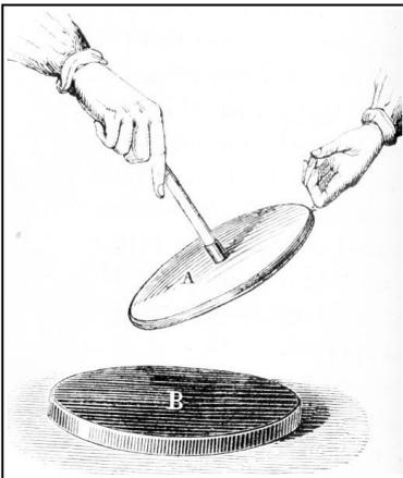
47\*. Si el electróforo anterior, separas el disco A de la torta resinosa B, y luego tocas la otra cara del disco, como observas en el dibujo, salta una chispa eléctrica. Esto es debido a que:
